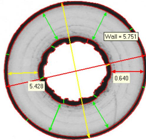
Le système de mesure réalise rapidement un nombre important de mesures bi-dimensionnelles. Les valeurs maxi et mini, ainsi que la moyenne, la concentricité et l'ovalité sont représentées. La surface de la section de l'isolant est également mesurée, outil indispensable pour minimiser les coûts de matière.
